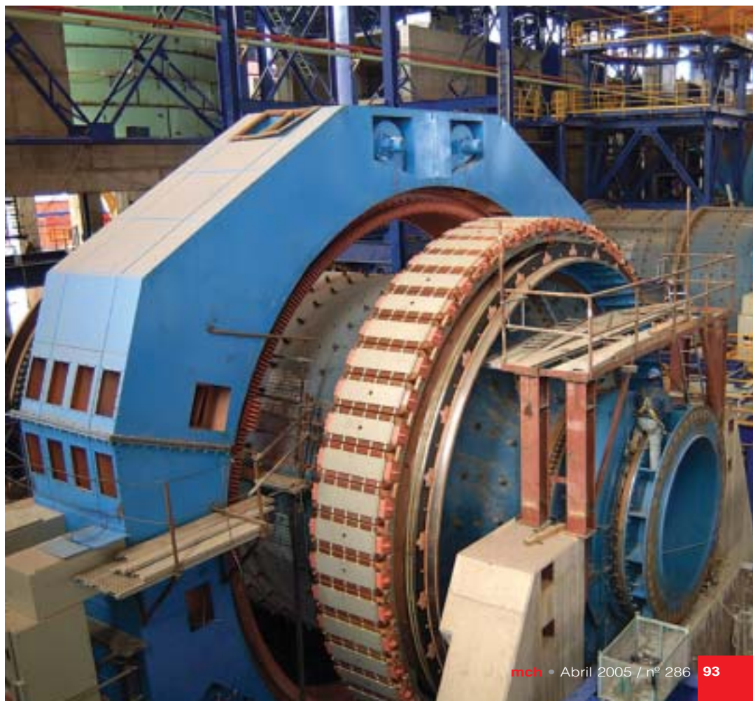
Nuevo molino SAG de 26.000 hp y 38 x 22 pies en el Concentrador Colón, 2003.
